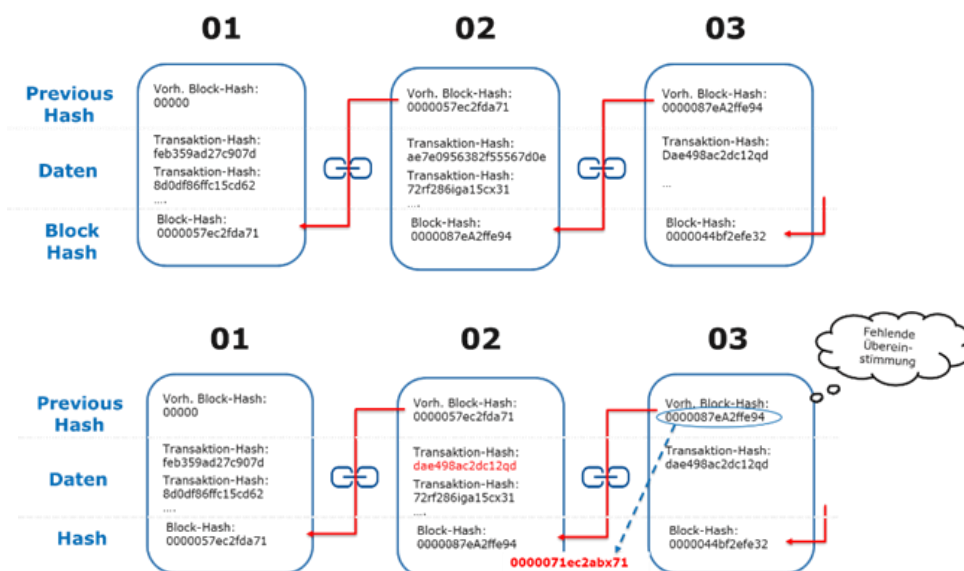
Abb. 4: Blockaufbau und -struktur (eigene Darstellung)
