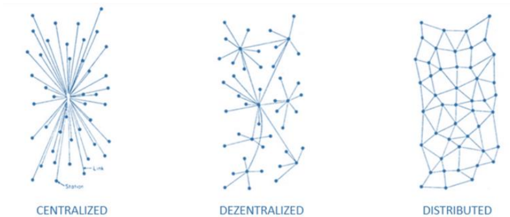
Abb. 6: Unterschiede de-/zentraler und verteilter Netzwerktopologie (Swanson 2015)
